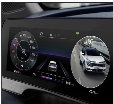
Um novo patamar de segurança é garantido através das câmeras instaladas nos retrovisores externos que captam as imagens dos pontos cegos do veículo e projetam no painel digital de instrumentos.
